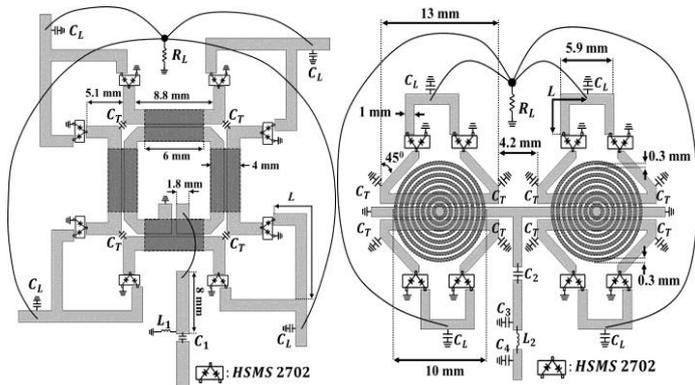
Fig. 1 Layout of the proposed rectifier. (a) SDT rectifier ( $=1\text{ pF}$ ,  $=22\text{ nH}$ ,  $=9\text{ pF}$ ,  $=1\text{ uF}$ ,  $=10\ \Omega$ , and  $=15.5\text{ mm}$ ), (b) PDT rectifier. ( $=6.8\text{ pF}$ ,  $=7\text{ pF}$ ,  $=3.3\text{ nH}$ ,  $=1\text{ pF}$ ,  $=3.3\text{ pF}$ ,  $=1\text{ uF}$ ,  $=10\ \Omega$ , and  $=7\text{ mm}$ )
